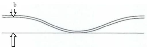
**Welligkeit** in mm entspricht der max. Wellenhöhe gemessen von der Auflagetischkante bis zur Produktunterseite. (siehe Skizze). Legen Sie dazu die Bahn spannungsarm auf einen geraden Tisch.
