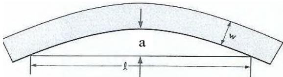
**Bogenförmigkeit** in mm auf 5000 mm Meßstrecke. Legen Sie dazu die Bahn gerade auf einen mindestens 6 m langen Tisch und messen Sie auf der Distanz von 0 bis 5000 mm (l) den größten Abstand (a) aus der Geraden lt. Skizze
